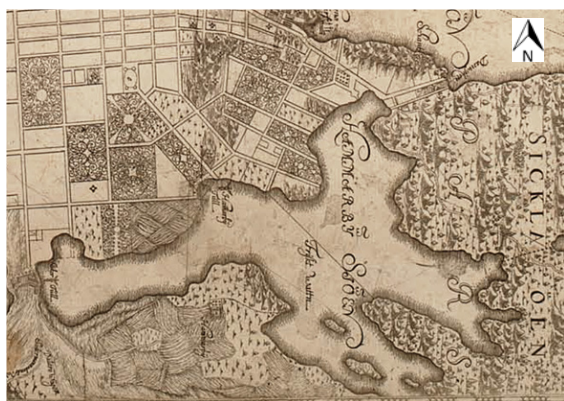
Figur 24. Hammarby sjö var ursprungligen en fristående sjö, separerad från både Mälaren och Saltsjön fram till 1929 då Danvikskanalen byggdes. Därefter har grunda delar fyllts ut och kajer anlagts. Vattenförekomsten Strömmens hydromorfologi har således ändrats radikalt jämfört med ett referensförhållande. (Ur kartan Svea rikets hufvudstads Stockholm 1702).
